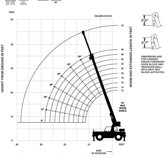
OPERATING RADIUS IN FEET FROM AXIS OF ROTATION BOOM DEFLECTION NOT SHOWN
